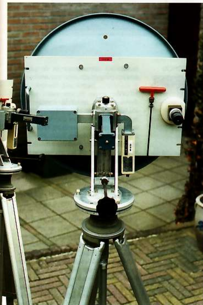
Achterzijde van het mobiele 10 GHz.station
